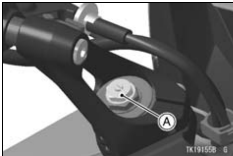
A. Spring Preload Adjuster
