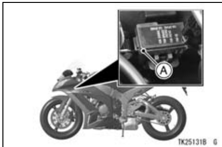
A. Fuse Box
