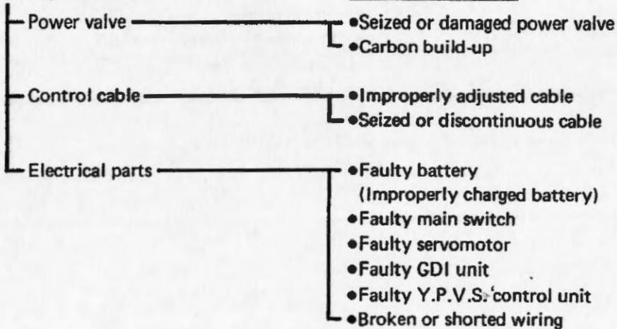
**FAULTY GEAR SHIFTING**
