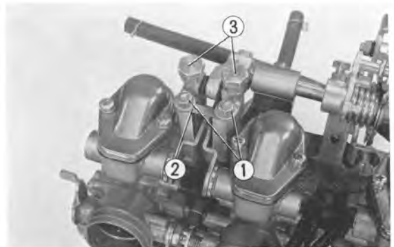
Fig. 171 ① Hex. nuts ③ Cap nuts ② Dust plate B
